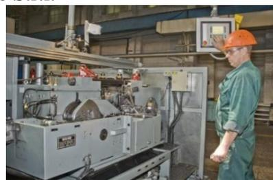
Рисунок 5. Однопозиционный двухударный автомат ND 90 фирмы WAFIOS
