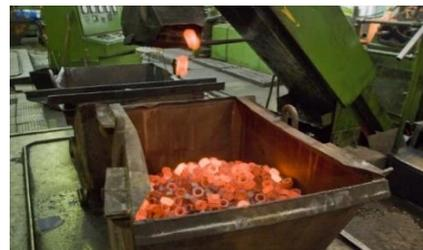
Рисунок 1. Штамповка гаек на автомате AMP 30
