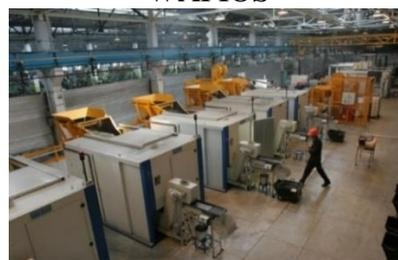
Рисунок 6. Резбонакатные станки FN 6-60, FN 6/8-80 фирмы HILGELAND
